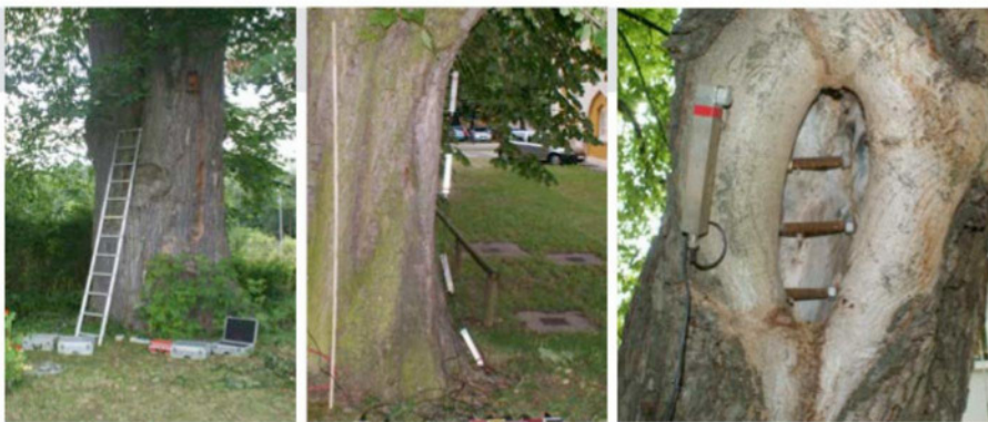
Abb. 2: Begleitende Zugversuche mittels Inclino/Elastomethode.
